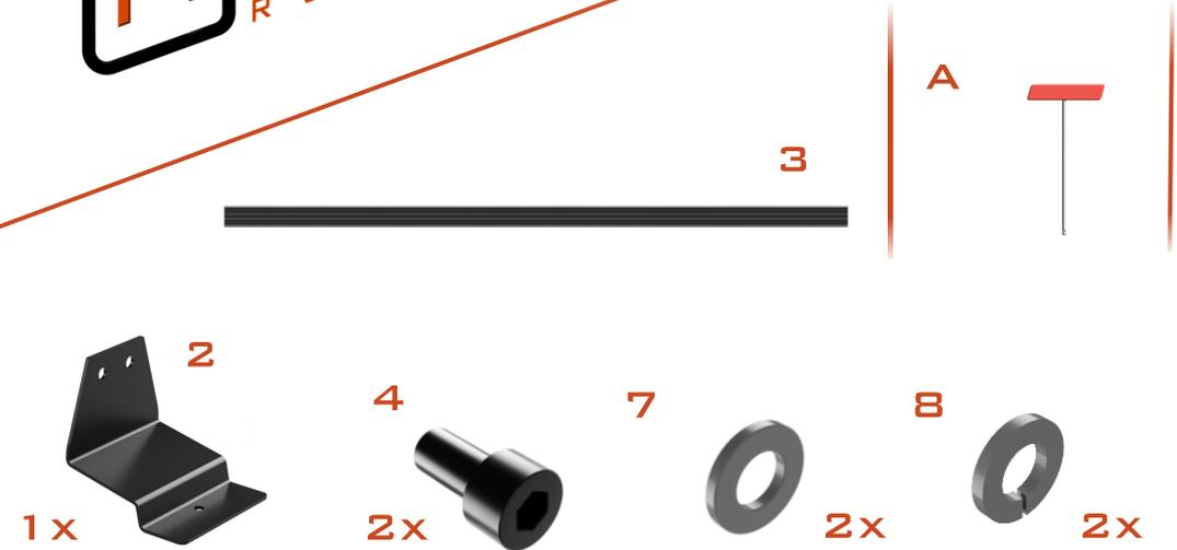
2.) SCHRAUBEN SIE DIE ZYLINDERKOPFSCHRAUBEN (4) IN DIE STIRNSEITIGEN GEWINDE DER QUERSTREBEN (3). ACHTEN SIE DABEI AUF DIE KORREKTE REIHENFOLGE VON FEDERRING (8) UND UNTERLEGSSCHEIBE (7).
